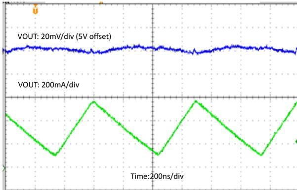
Figure 4-7. TPS61099 Vin 3.6 V, Vout 5 V, Iout 300 mA
