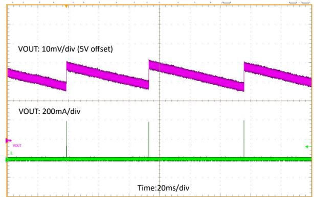
Figure 4-8. TPS61299 Vin 3.6 V, Vout 5 V, Iout 0 A
