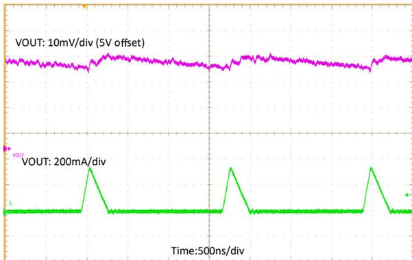
Figure 4-9. TPS61299 Vin 3.6 V, Vout 5 V, Iout 25 mA
