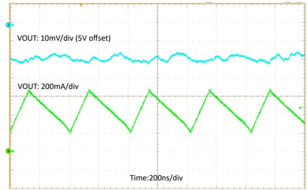
Figure 4-10. TPS61299 Vin 3.6 V, Vout 5 V, Iout 300 mA
