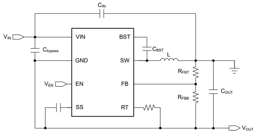
**Figure 1-2. Buck-Boost Converter Application**
