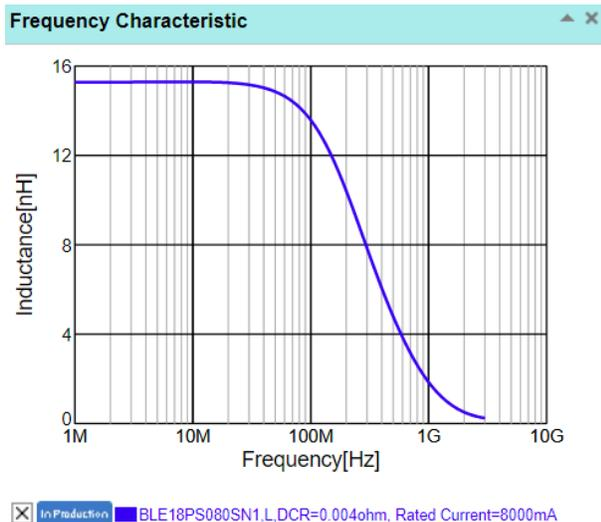
**Figure 4-3. BLE18PS080SN1 Inductance VS Frequency**
