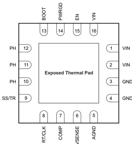
**Figure 4-1. Pin Diagram**
