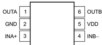
**Figure 4-1. Pin Diagram (DDC) Package)
