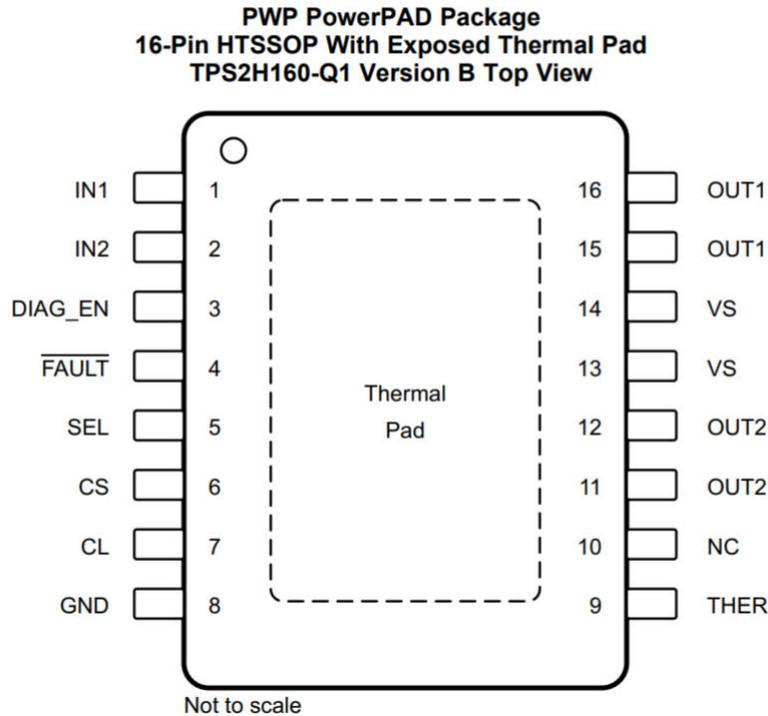
**Figure 4-1. Pin Diagram**
