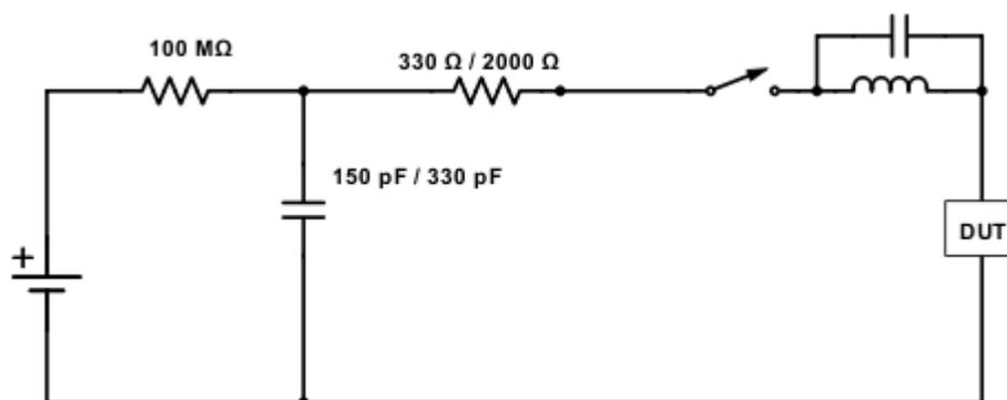
**Figure 2-1. ISO 10605 Equivalent Circuit**
