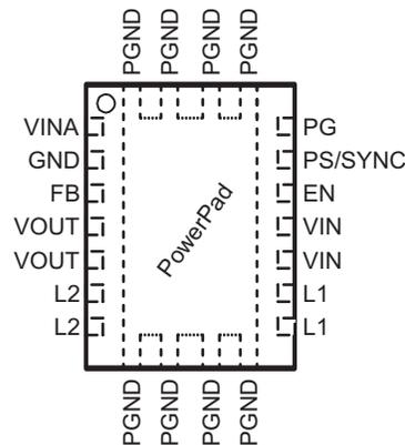
**Figure 1. TPS63020-Q1 DSJ Package Pin-Out (Top View)**
