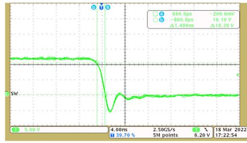
Figure 2-5. TPS566242 Falling Edge
