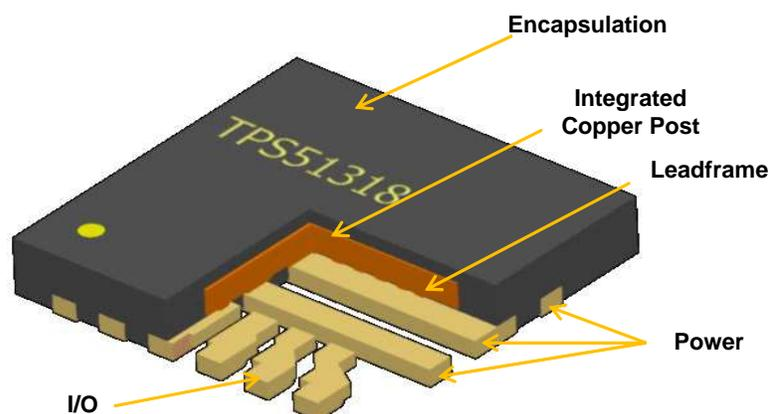
Figure 1. HotRod QFN Structure And Die Attachment
