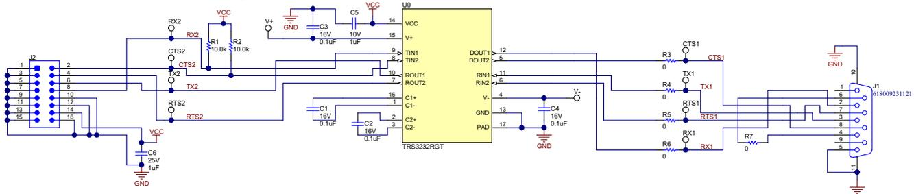
**Figure 4-1. TRS3232RGTEVM schematic**
