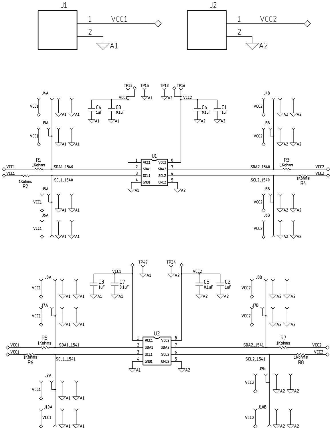
**Figure 1-3. ISO154xEVM Schematic**
