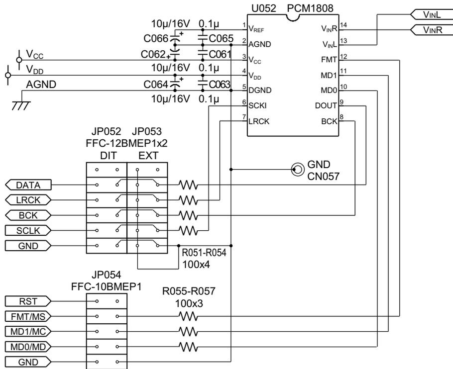
Figure 2-3. DEM-DAI1808 ADC Section
