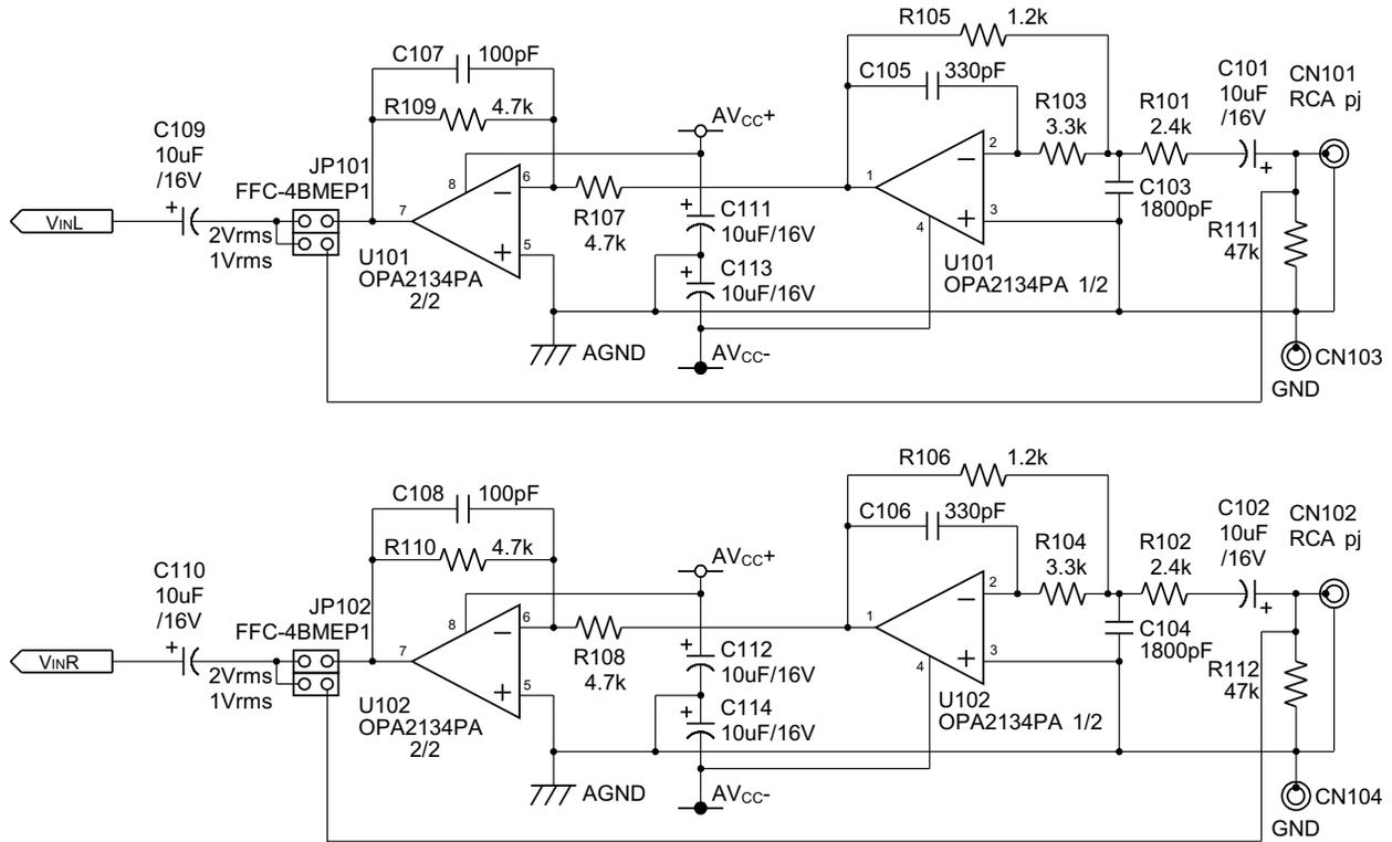
Figure 2-4. DEM-DAI1808 Analog Section
