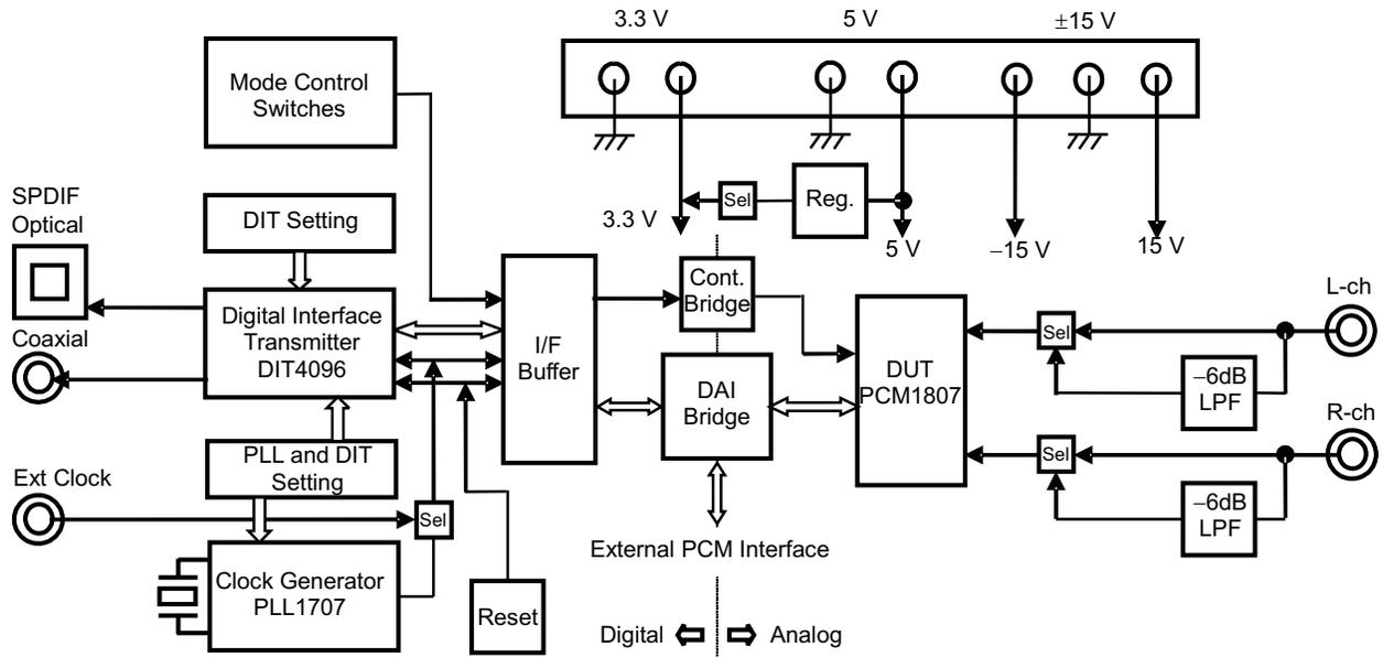
Figure 1-1. DEM-DAI1808 Block Diagram
