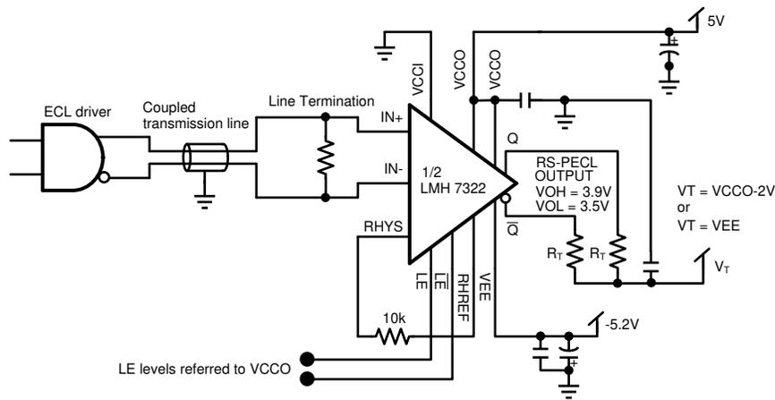
Figure 2-11. RSPECL Termination
