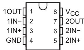
**Figure 2. Pin Diagram**
