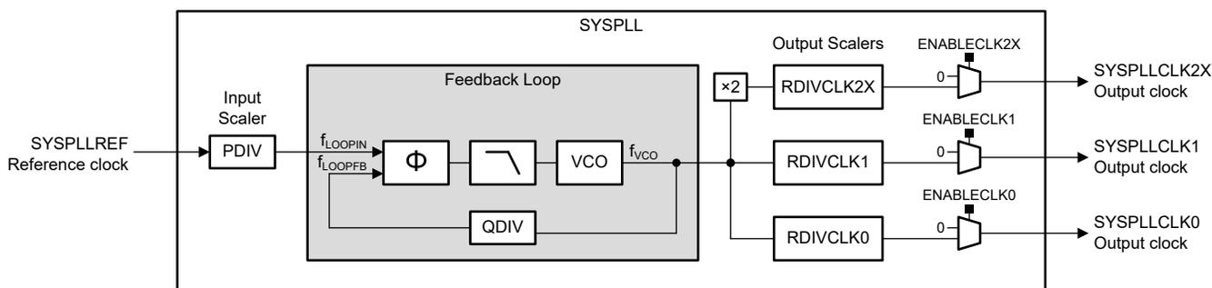
Figure 2-7. SYSPLL Diagram
