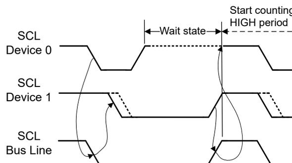
**Figure 24-9. Clock Synchronization**
