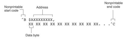
Figure 12-6. ASCII-Hex Object Format
