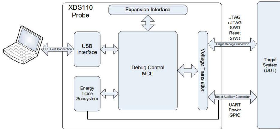
Figure 5-4. XDS110 Probe High-Level Block Diagram
