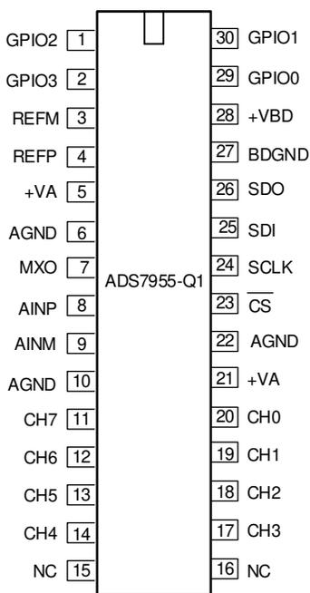
**Figure 4-1. Pin Diagram**
