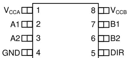
**Figure 4-1. Pin Diagram**
