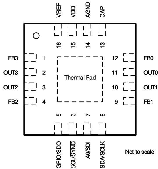
**Figure 4-1. Pin Diagram**
