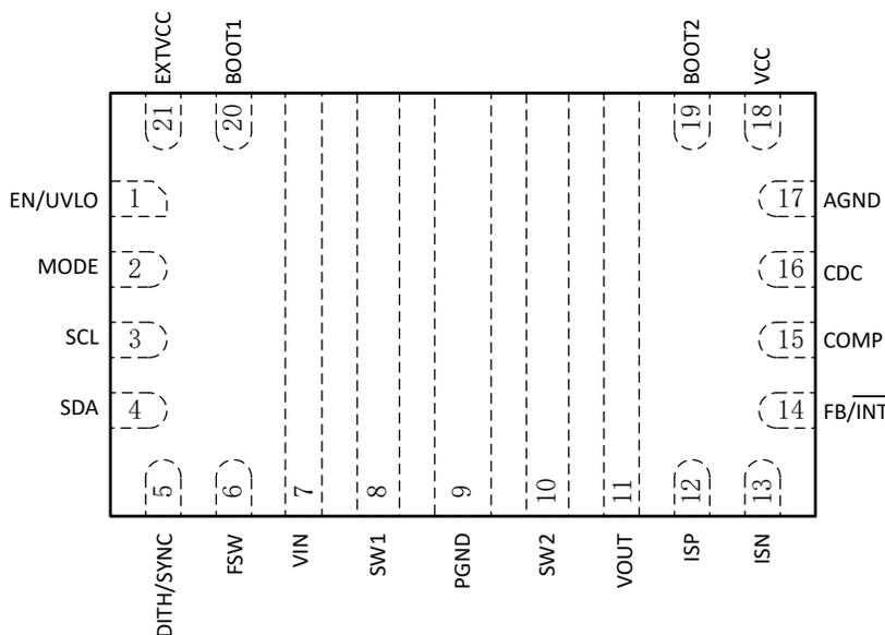
**Figure 4-1. TPS55289-Q1 Pin Diagram**
