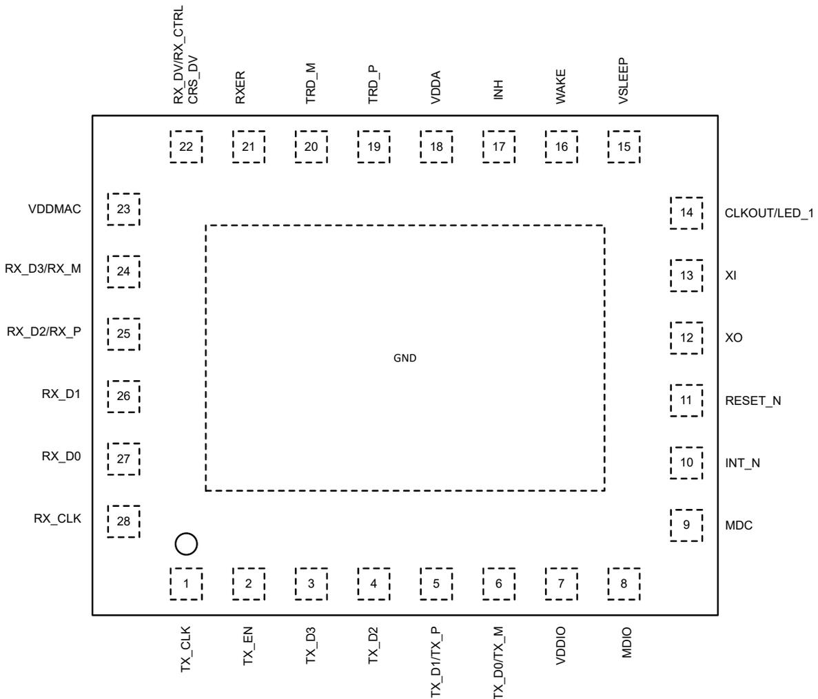
**Figure 4-1. DP83TC813S-Q1 Pin Diagram**
