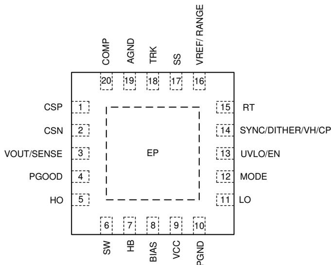
**Figure 4-1. Pin Diagram**
