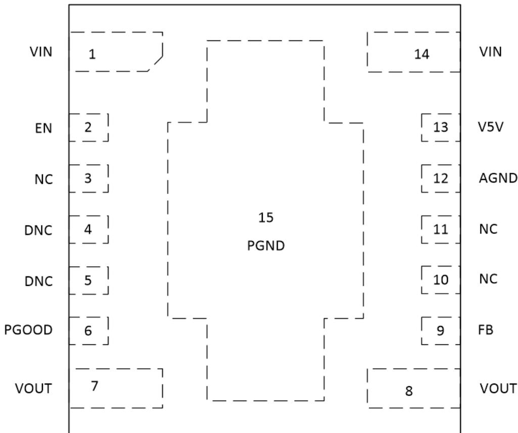
**Figure 4-1. Pin Diagram**
