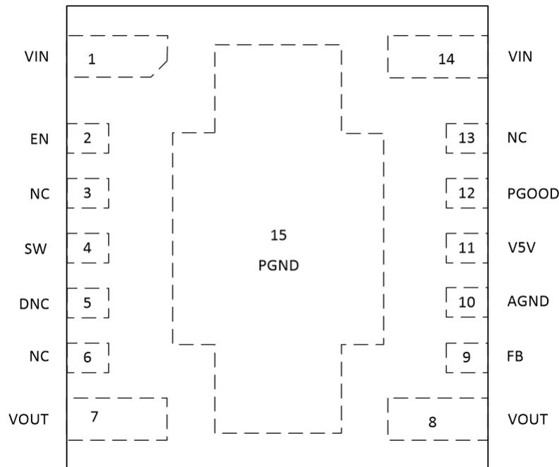
**Figure 4-1. Pin Diagram**
