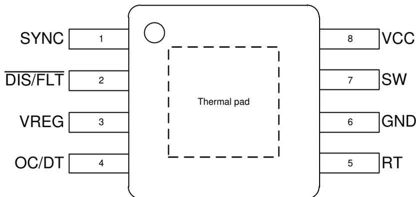
**Figure 4-1. Pin Diagram**
