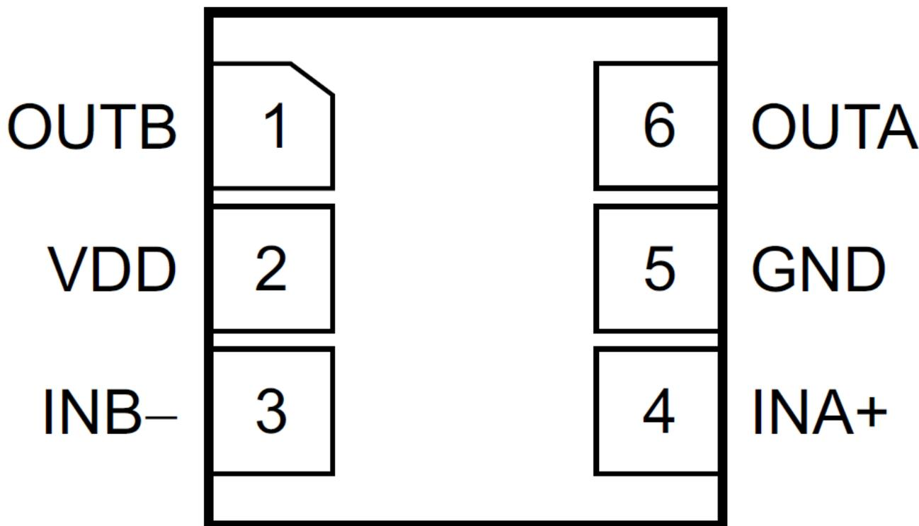
**Figure 4-1. Pin Diagram**
