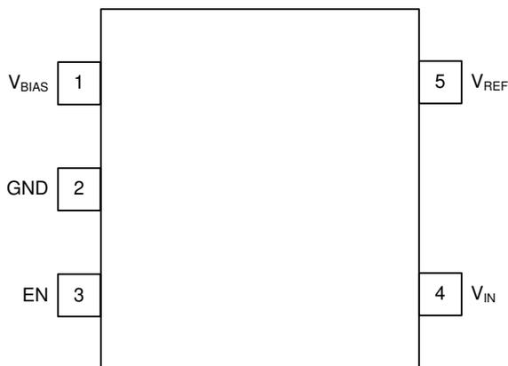
**Figure 4-1. Pin Diagram**
