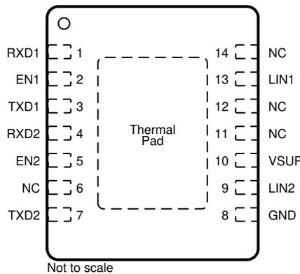
**Figure 4-1. DRB Pin Diagram**
