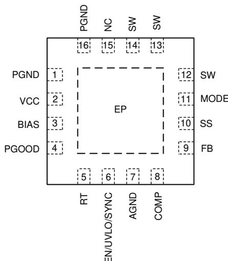
**Figure 4-1. Pin Diagram**
