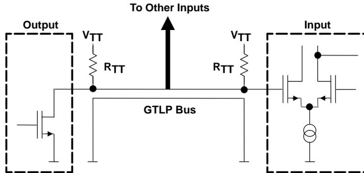
**Figure 18. GTLP Bus: An Open-Drain Bus**
