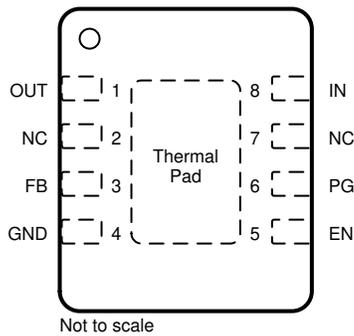
**Figure 4-3. Pin Diagram Adjustable TPS745-Q1 DRB Package**
