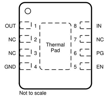
**Figure 4-4. Pin Diagram Fixed TPS745-Q1 DRB Package**
