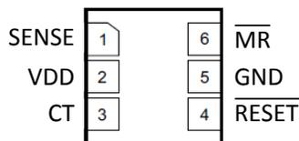
**Figure 4-1. Pin Diagram DSE Package 6-Pin WSON**
