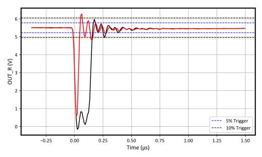
Figure 5-4. Worst Case Transient Plot (Run 4 - R Pin)
