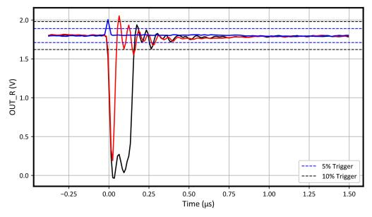
Figure 5-3. Worst Case Transient Plot (Run 2 - R Pin)
