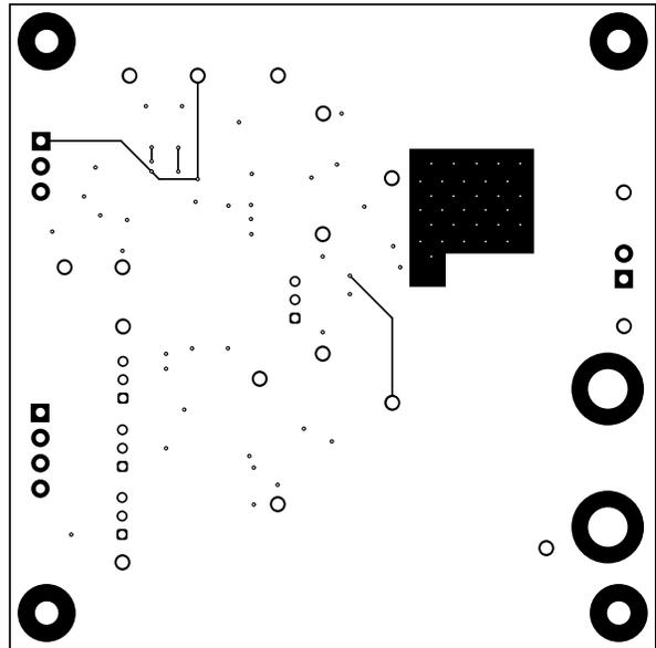
Figure 8-6. PCB Bottom Layer
