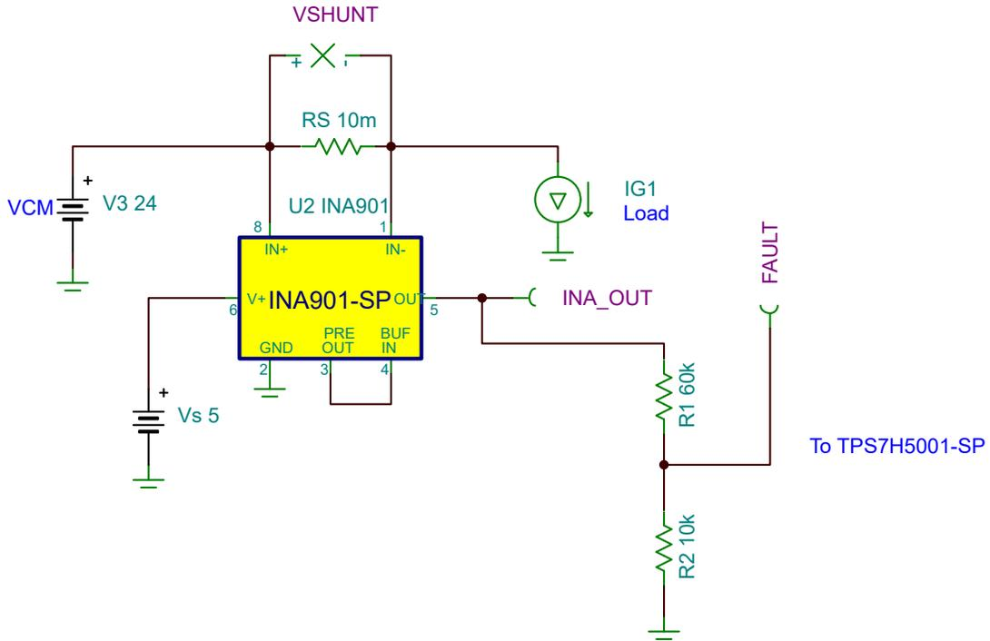
**INA901-SP TINA-TI Circuit Simulation Setup**
