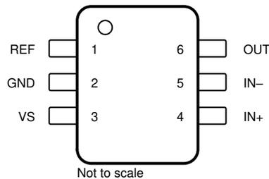
**Figure 4-1. Pin Diagram**
