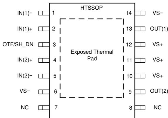
**Figure 4-1. Pin Diagram**
