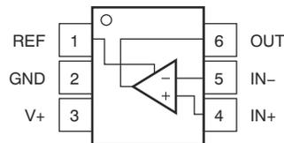
**Figure 4-1. Pin Diagram**
