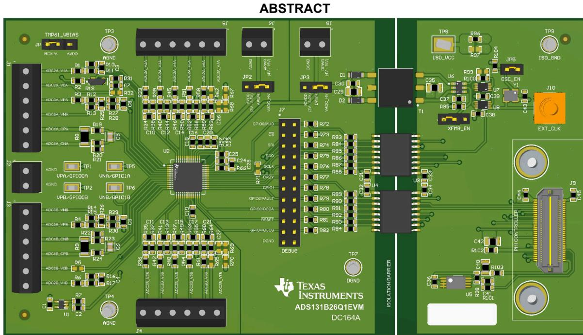
**Figure 1-1. ADS131B26Q1EVM-PDK Evaluation Module**
