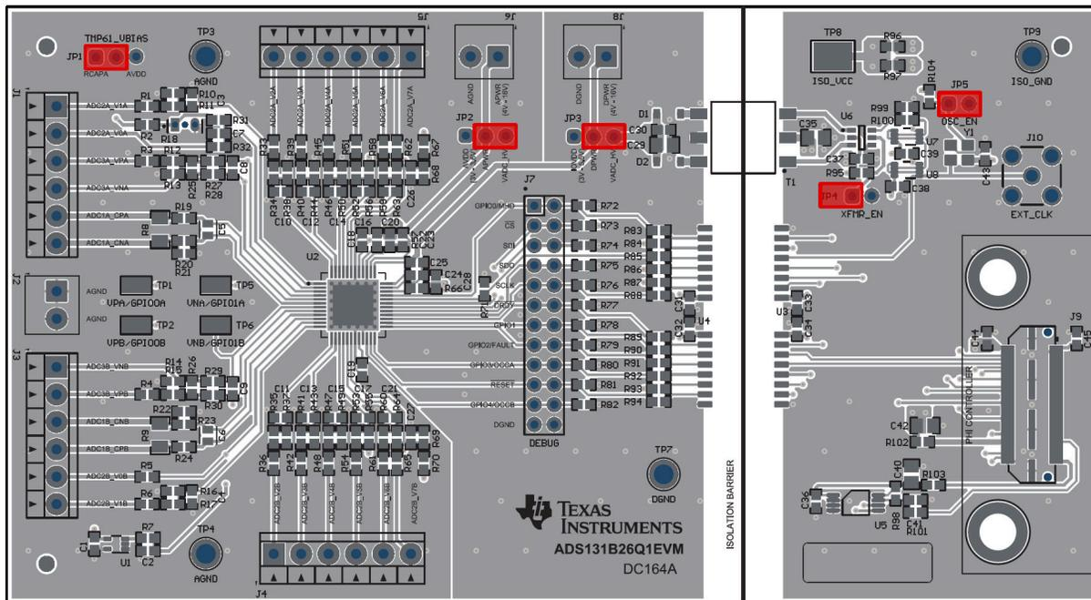
**Figure 5-1. ADS131B26Q1-PDK Jumper Default Settings**
