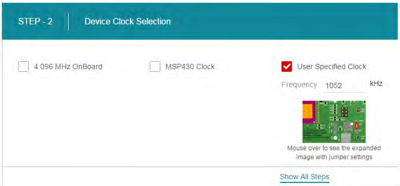
Figure 22. ADS1282-SP GUI Quick Start Step 2
