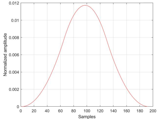
**Figure 3-7. Sinc<sup>3</sup> OSR64 Filter Coefficients**
