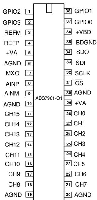
**Figure 4-1. Pin Diagram**
