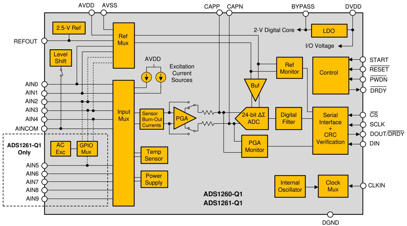
Figure 3. ADS1260-Q1 and ADS1261-Q1 Block Diagram
