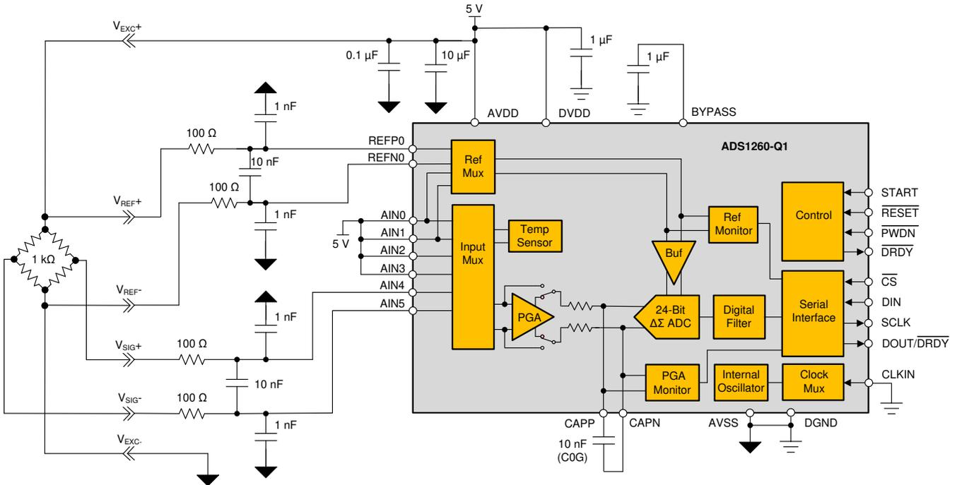
Figure 4. Implementation of an OBW System Using ADS1260-Q1
