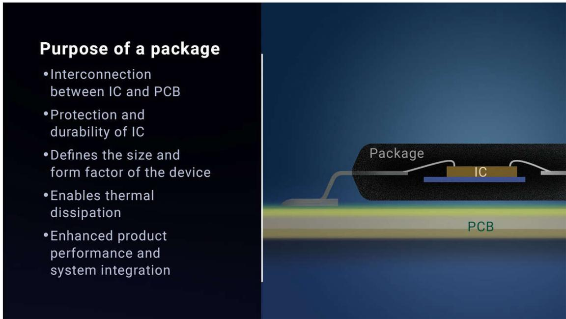
圖 1. 典型類比封裝的內部圖，以及封裝所實現的功能。
