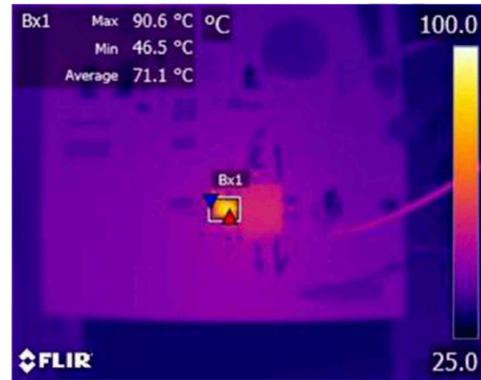
圖 14. 採用強化式 HotRod QFN 封裝且具 DAP 的 LM60440 熱性能，平均溫度可降至 71.1°C。
