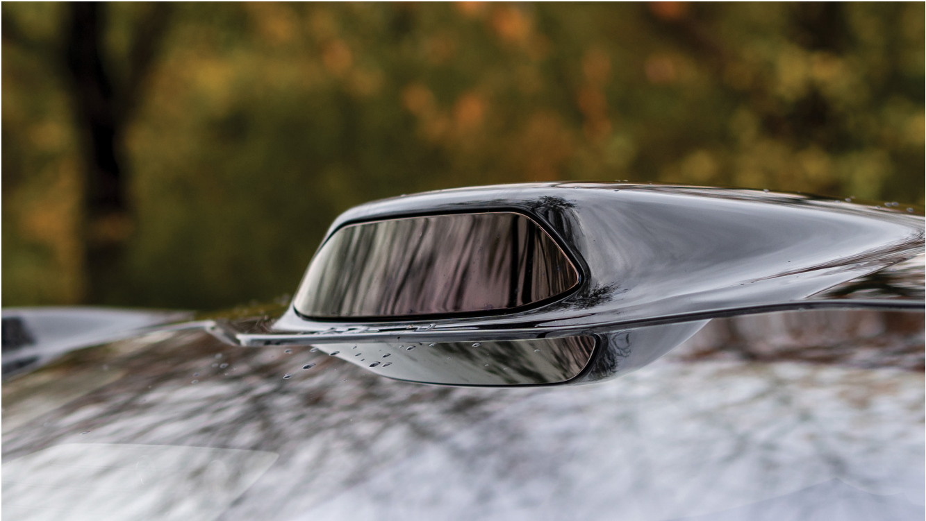
图 2. 安裝在車輛頂部的的光達模組
