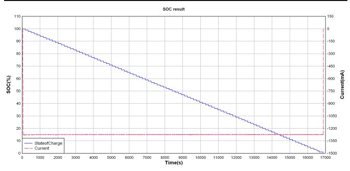
图 1. 恆定放電電流下的放電充電狀態測試結果
