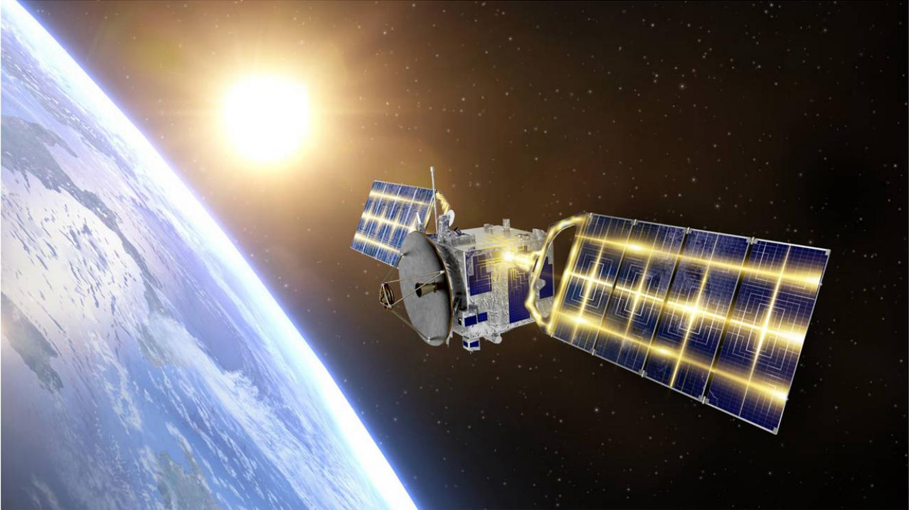
위성 산업에서는 로컬 데이터 처리의 급증, 고처리량 통신 링크에 대한 지원, 전기 추진 시스템의 빠른 도입이 고성능 전력 시스템(EPS)에 대한 수요를 주도하고 있습니다. EPS는 위성의 버스 섹션의 일부로, 전원, 열 관리, 통신 및 추진과 같은 구조적 지원과 하우징 하위 시스템을 제공합니다. EPS는 위성의 다른 모든 하위 시스템과 페이로드로 전력을 생성, 저장, 조정 및 분배합니다.
